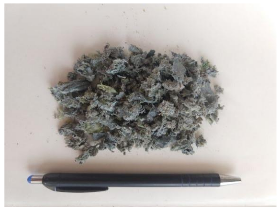
Фиг. 4 – Краен продукт от третирането на отпадък от процеса на екструзия
